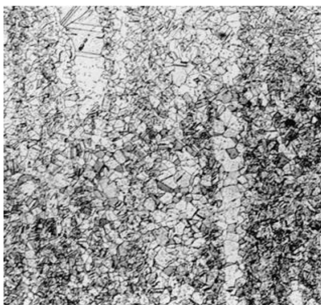
شکل ۱۷. ریز ساختار IN-۷۱۸ بیانگر اندازه دانه ایجاد شده با دمای فورج خیلی زیاد
