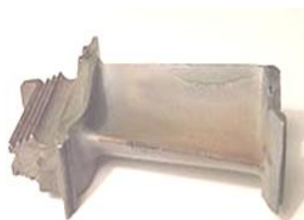
شکل ۱. موتور جت از نوع سوپرآلیاژ پایه نیکل
