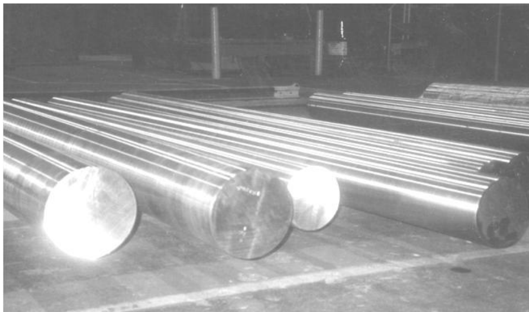
شکل ۳. بیلت های اولیه سوپرآلیاژ پایه نیکل waspaloy برای برش داخل قطعه های مختلف برای فورج
