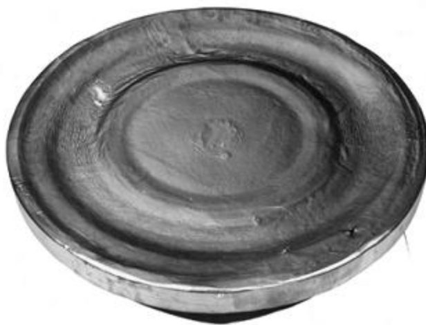
شکل ۵. قطعه فورج شده قالب بسته سوپرآلیاژ پایه نیکل waspaloy تولید شده از پنکیک در شکل (۴)
