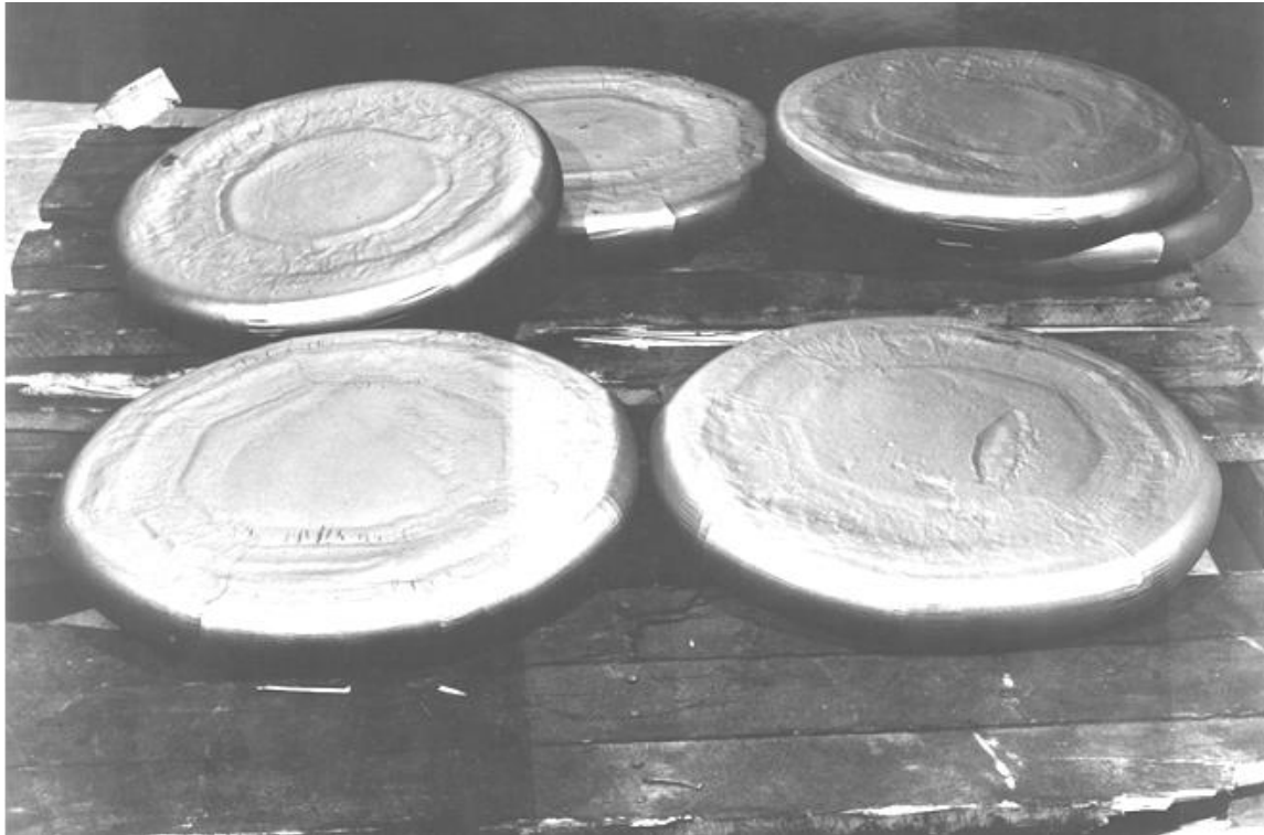
شکل ۴. قطعه فورج (پنکیک) قالب باز سوپرآلیاژ پایه نیکل waspaloy
